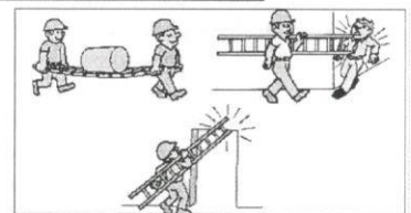
Fig. 1 Formas incorrectas de transportar la escalera
